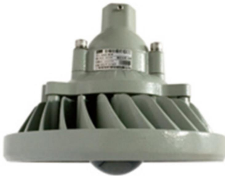
根据欧洲标准EN13463-1-2002《性环境用非电气设备第1部分：基本方法与要求》的防爆概念和防火类型，隔爆型是采取措施允许内部并阻止火焰传爆的一种防爆型式，是常用的一种防爆类型。由于这种防爆类型的灯具外壳一般使用金属材料制造，散热性好，外壳强度高和耐用性好，很受用户欢迎。而且，许多增安型防爆灯具部件，如灯座、联锁开关等，也采用隔爆型结构。如果性气体混合物进入隔爆外壳并被点燃，隔爆外壳能承受内部性气体混合物的压力，并阻止内部的向外壳周围性混合物传播。这是一种间隙防爆原理，即利用金属间隙能阻止火焰的传播和冷却产物的温度，达到火焰熄灭和降温，抑制的扩展的原理设计的一种构造。江苏天堡生产防爆照明灯具，专做防爆照明灯具产品. 杭州防爆灯具多少钱
